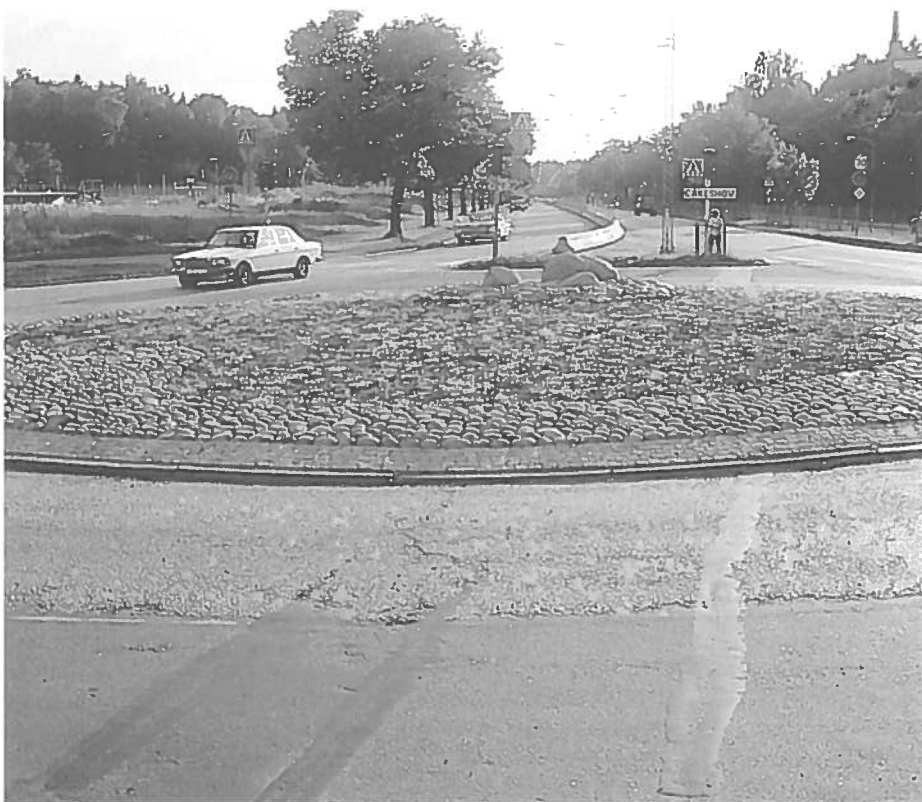
Figur 6. Korrekt anlagt rundkørsel med mos-sedum måtter i passende afstand fra kørebane.
